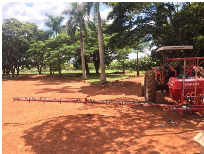
FIGURA 3: Pulverizador montado FM Copling, com sistema de pulverização eletrostático instalado.
