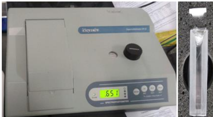
FIGURA 6: Espectrofotômetro e cubeta empregados no estudo de deposição
