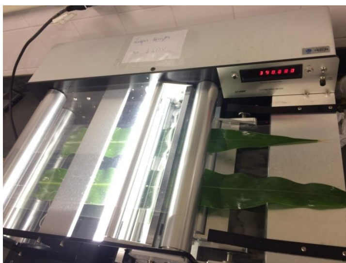
FIGURA 8: Medidor de área foliar Licor LI 3100C
