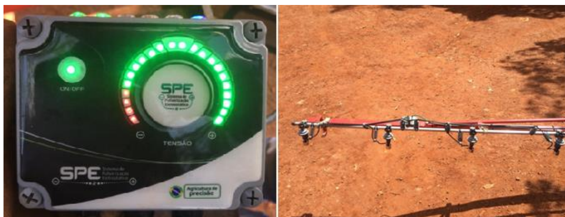
FIGURA 4: Sistema de Pulverização Eletrostático instalado na barra de pulverização
